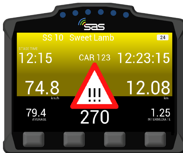
BILD 21: Warnung - Fahrzeug steht auf / neben der Strecke, Status noch nicht bestätigt HAZARD
